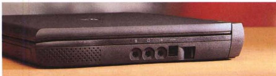
Sul lato destro si trovano uno dei due altoparlanti, i connettori della scheda audio e quello dell'alimentazione. All'interno della presa d'aria si intravede il dissipatore collegato al processore.
